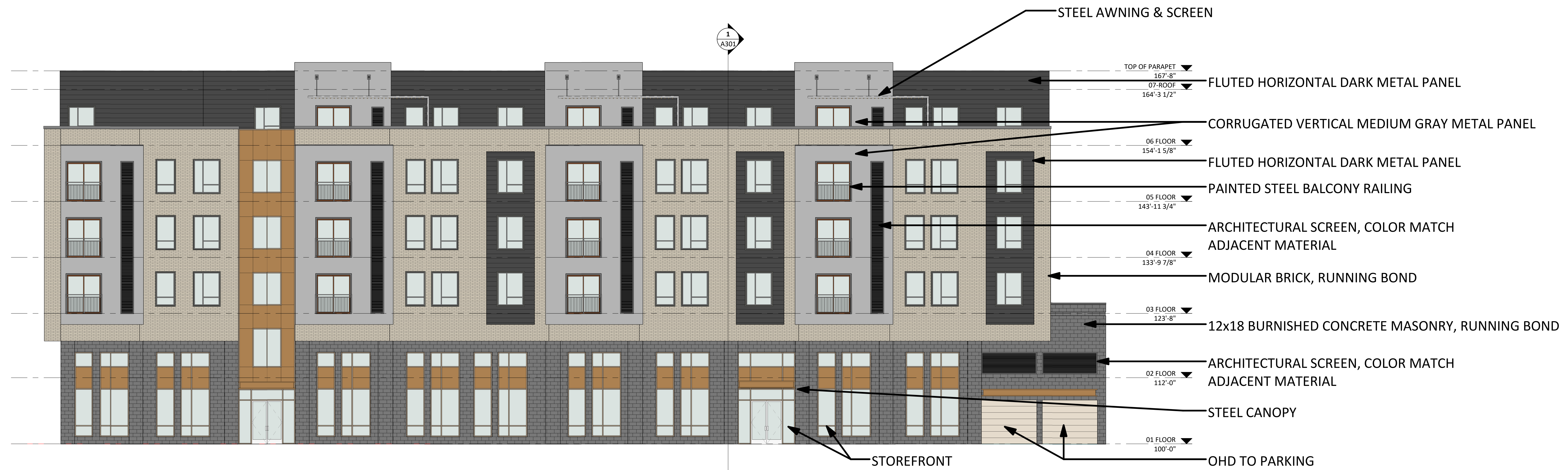
1 SOUTH ELEVATION SCALE: 1/8" = 1'-0"
