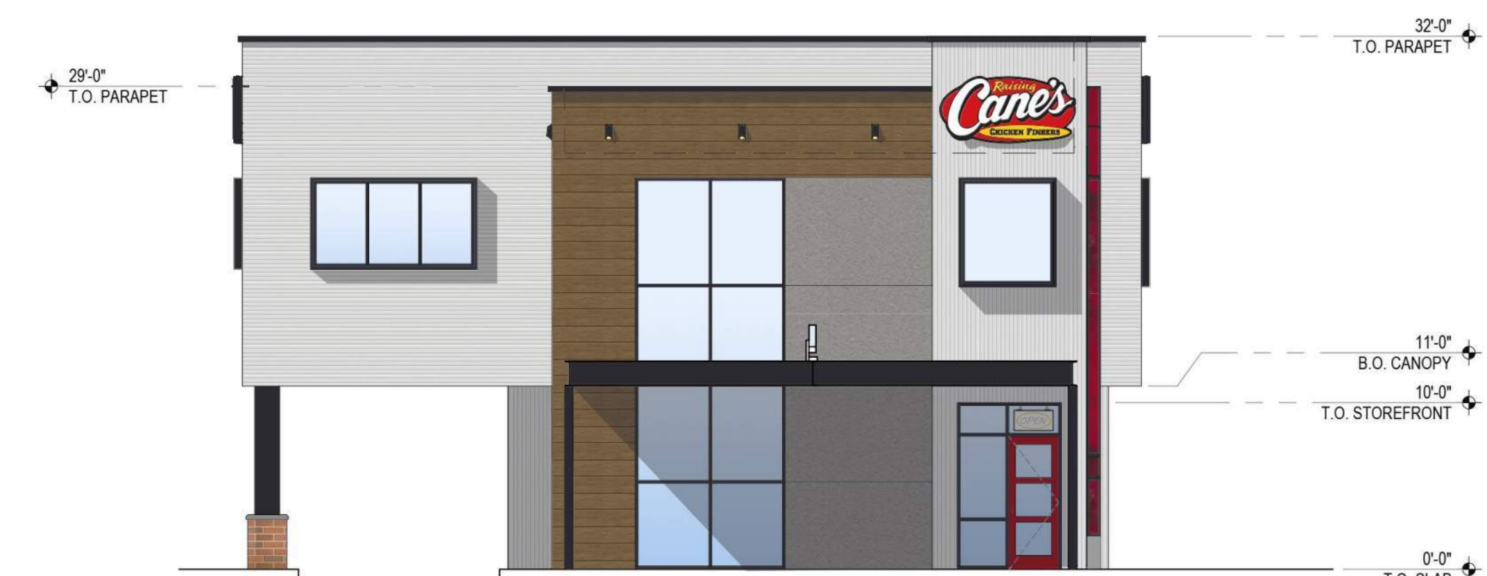
2 EAST ELEVATION SCALE: 1/8" = 1'-0"
