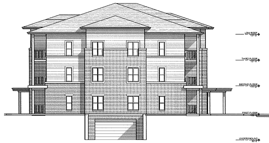
30 - UNIT WEST ELEVATION SCALE: 1/8" = 1'-0"
