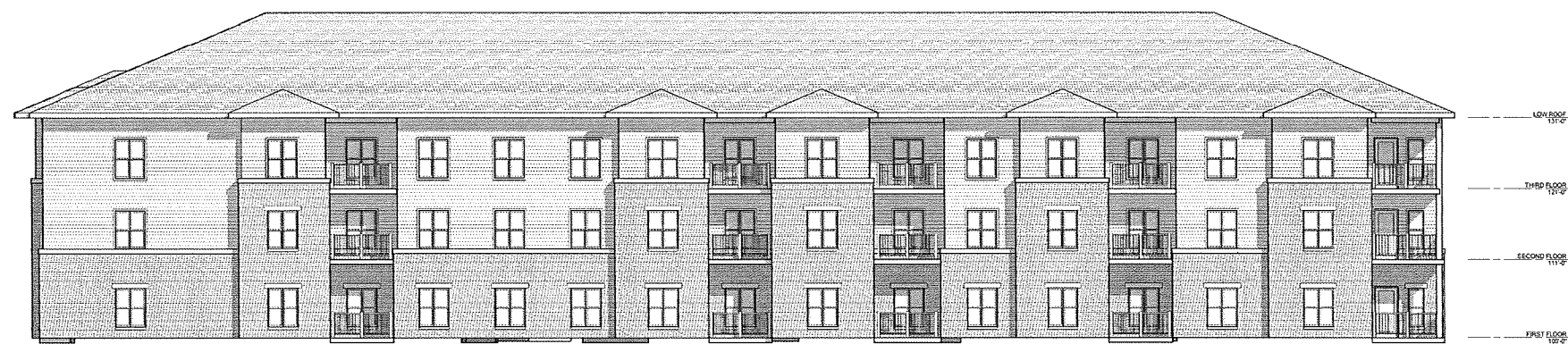
42 - UNIT WEST ELEVATION SCALE: 1/8" = 1'-0"
