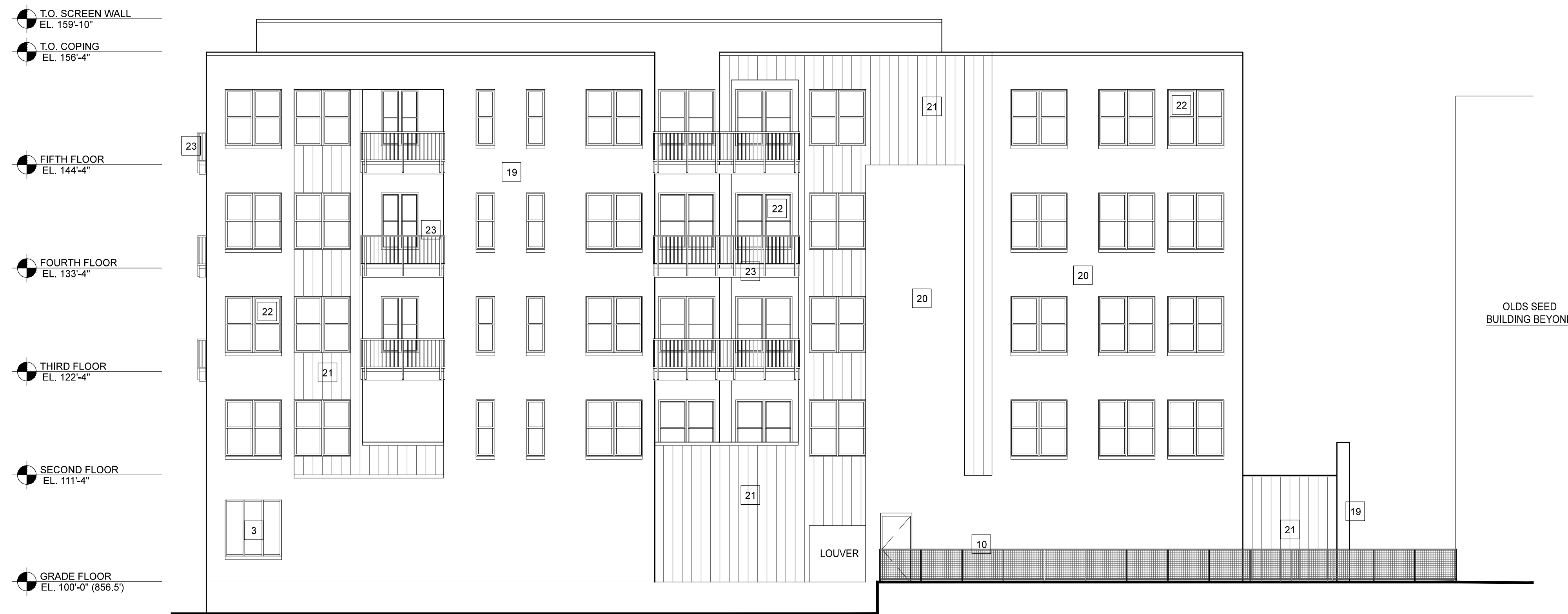
2 WEST ELEVATION SCALE: 1/8"=1'-0"
