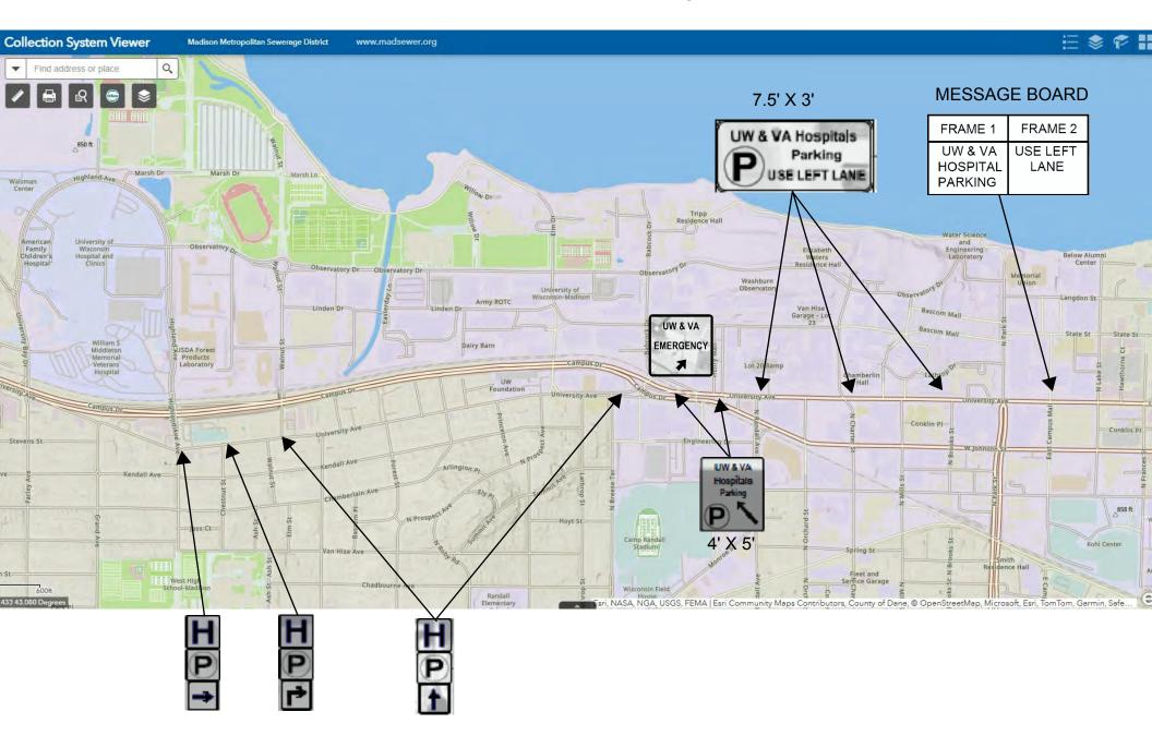
TRAFFIC CONTROL STAGE 1 ON-RAMP CLOSED: BYPASSING PIPE NEEDS TO BE PLACED ACROSS ON-RAMP ONE-DAY ONLY
